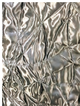
写真8 キルト加工の試験布
