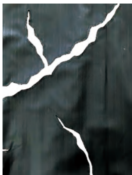
写真6 亀裂状にカットした試験布
